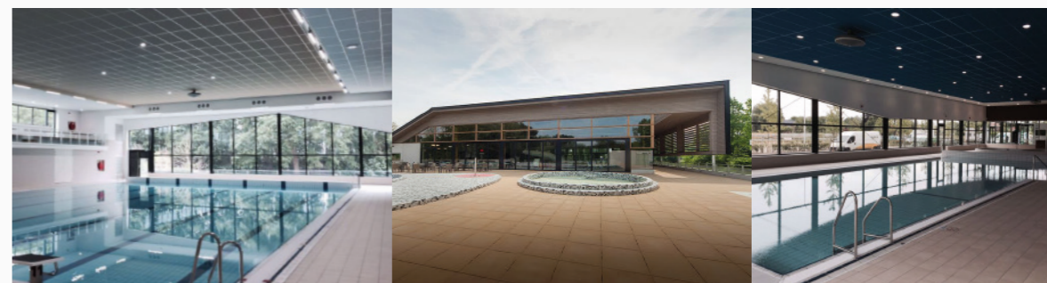
Referenties van het gebruik van relatief veel glas aan één of twee zijden van het zwembad. Het verhoogt de relatie met het buitenzwembad en ligweide en biedt zon- en daglichtintrede waardoor het gebruik van kunstlicht overdag beperkt kan blijven.
