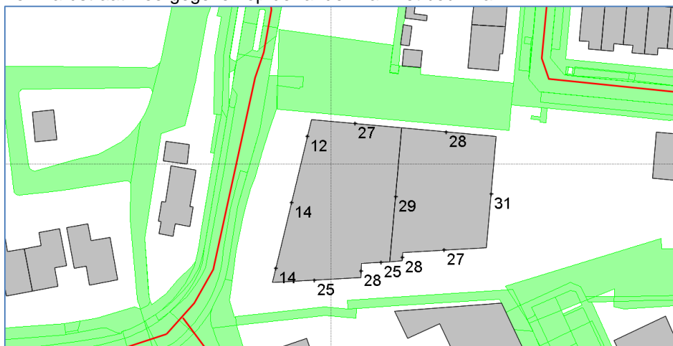
Figuur 5 Hoogst berekende geluidbelasting vanwege de Prins Bernhardstraat inclusief aftrek conform artikel 110g Wgh
