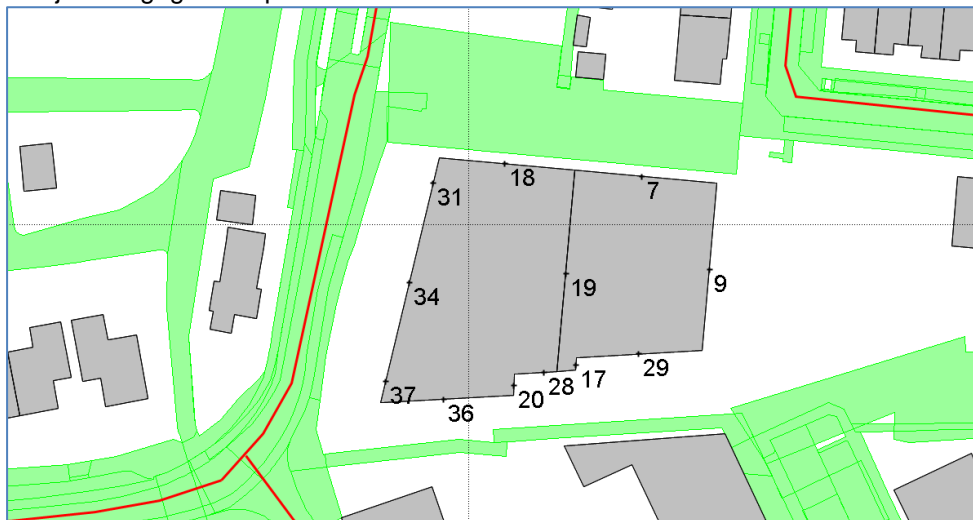
Figuur 4 Hoogst berekende geluidbelasting vanwege Kosterdijk inclusief aftrek conform artikel 110g Wgh
