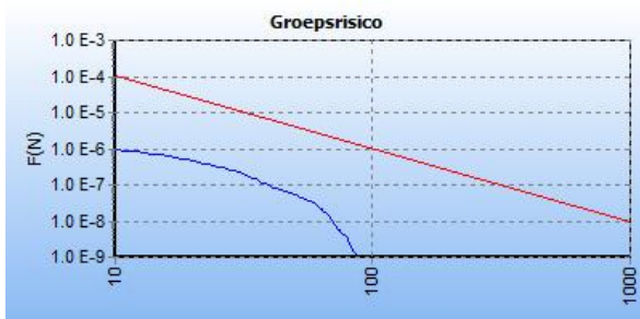
Figuur 8: FN curve van de kilometer met de hoogste overschrijdingsfactor (0.02) van de W-501-01. De ligging van de kilometer met de hoogste overschrijdingsfactor is hiernaast in het rood weergegeven op een topografische kaart.
