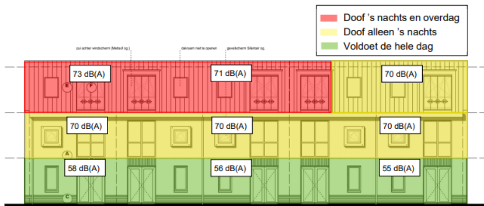
Afbeelding 11: Maximale geluidbelasting op de verdiepingen. Maximale grenswaarde overdag 70 dB(A), 's nachts 60 dB(A)
