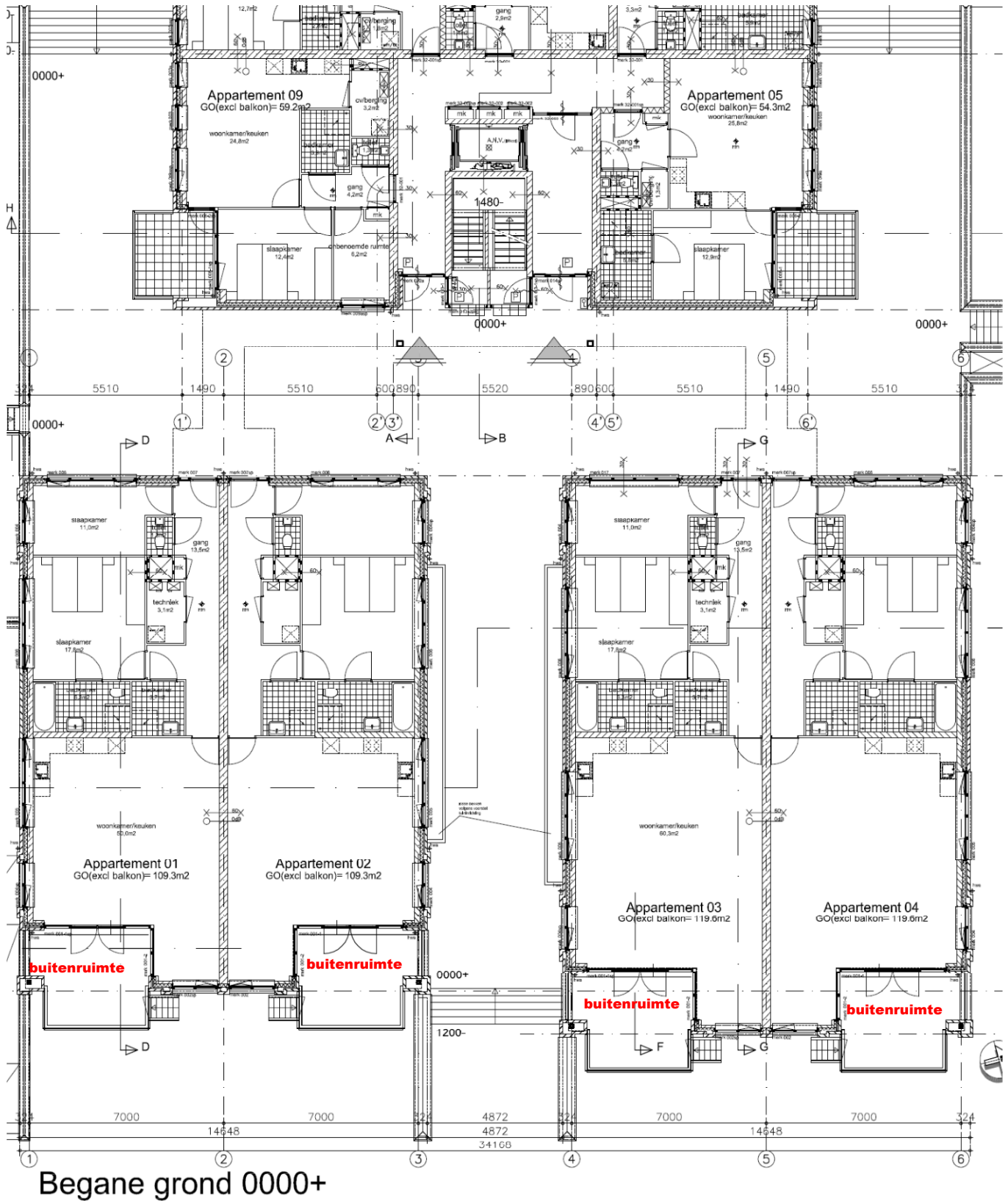
figuur 2 plattegrond begane grond appartement 01 t/m 04
