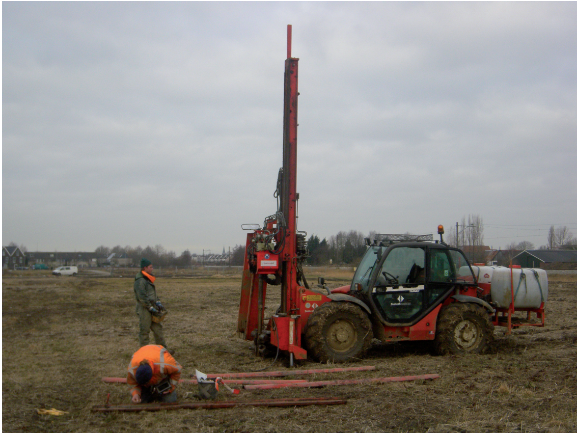
Figuur 4. Impressie van het veldwerk: het analyseren van de met de Aqualock en de Manitou genomen boor-monsters tijdens de karterende/waarderende fase van het booronderzoek.
