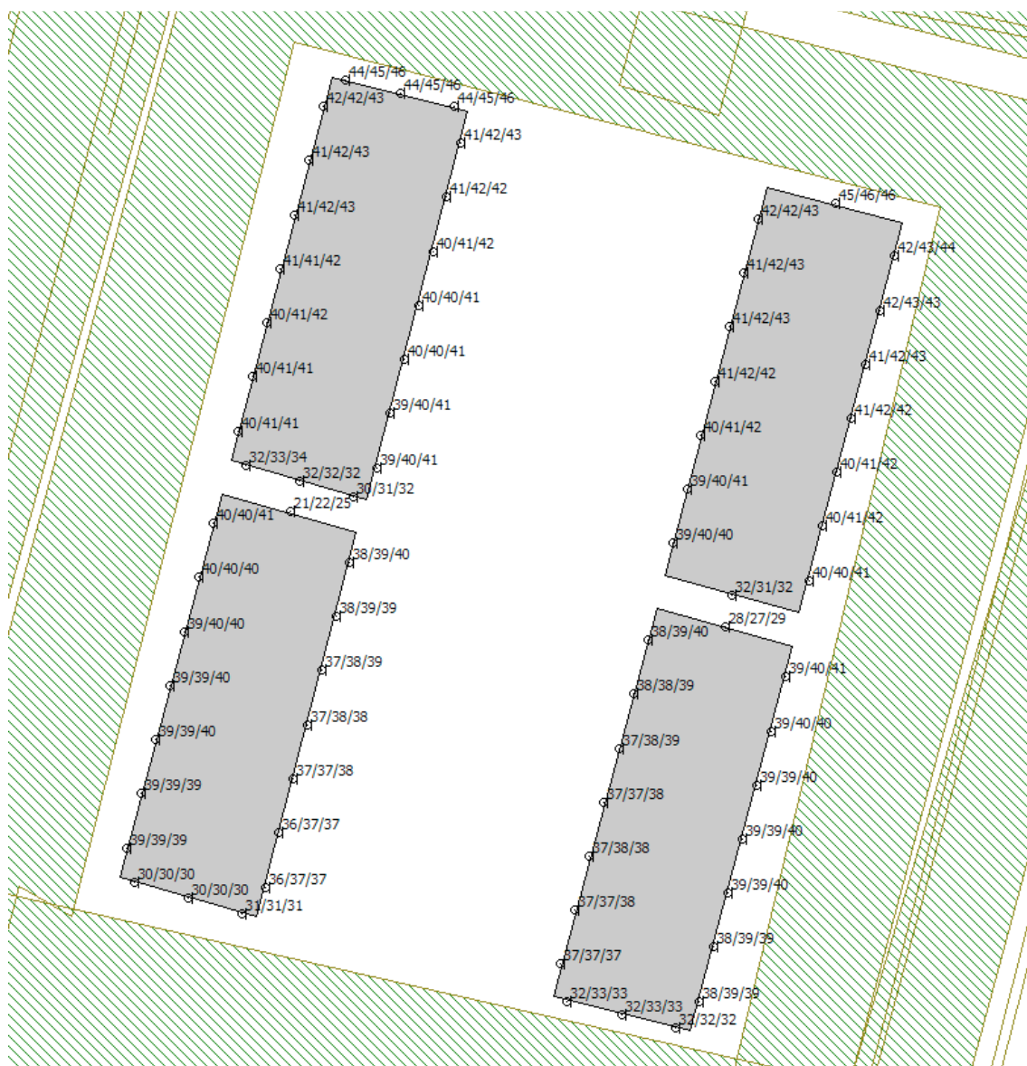
Figuur 4: Geluidsbelasting ten gevolge van het verkeer op de Oud Reeuwijkseweg / Oudeweg inclusief aftrek artikel 3.4 Rmg
