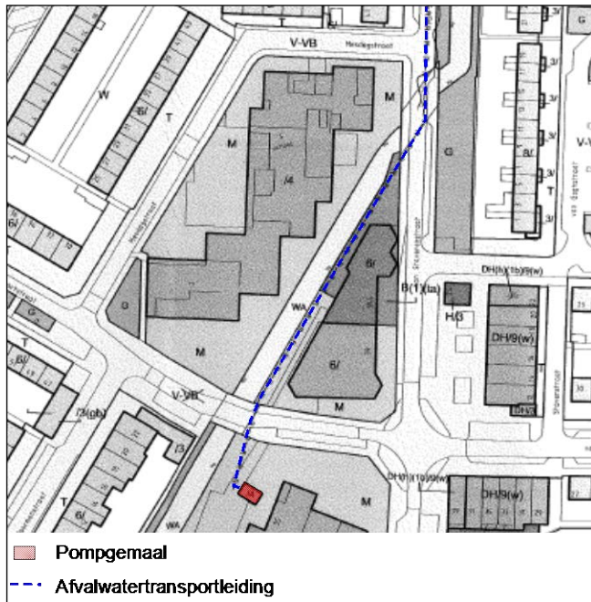
Figuur 4: Ligging bestaand pompgemaal en afvalwatertransportleiding
