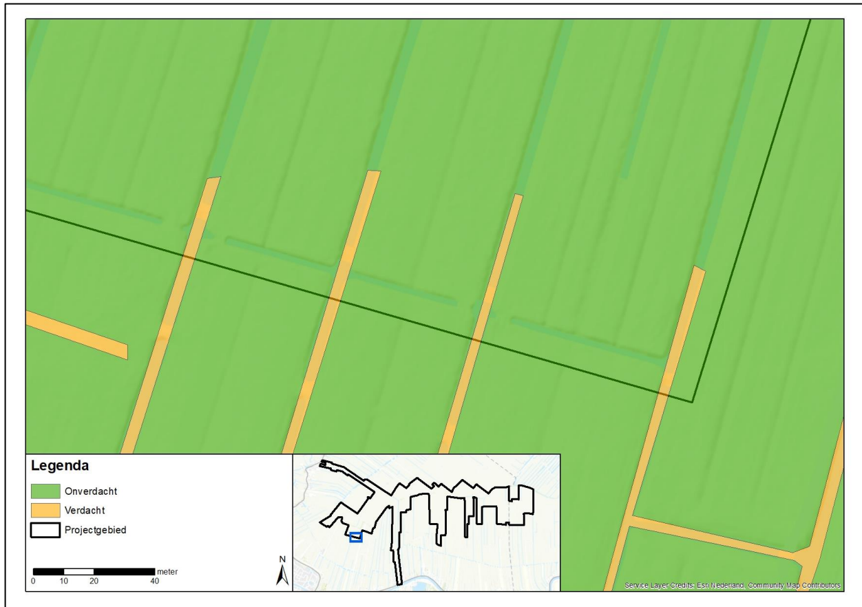
Afbeelding 2: uitsnede uit de tekening van het projectgebied met in geel de op OO en vliegtuigwrakdelen verdachte sloten.
