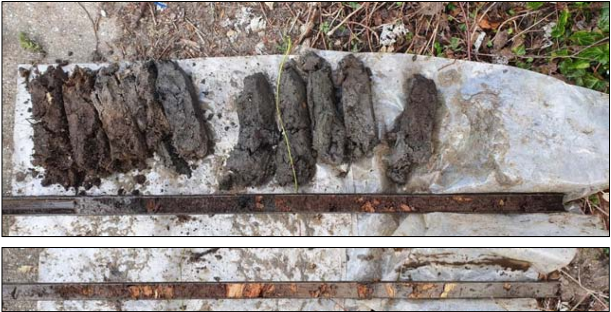
Boring 6. Boven: 0-200 cm -Mv. Onder: 200-300 cm -Mv.
