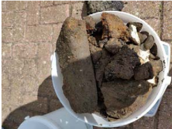
Deelplan B, inspectiesleuf SL103 (fractie > 20mm)
