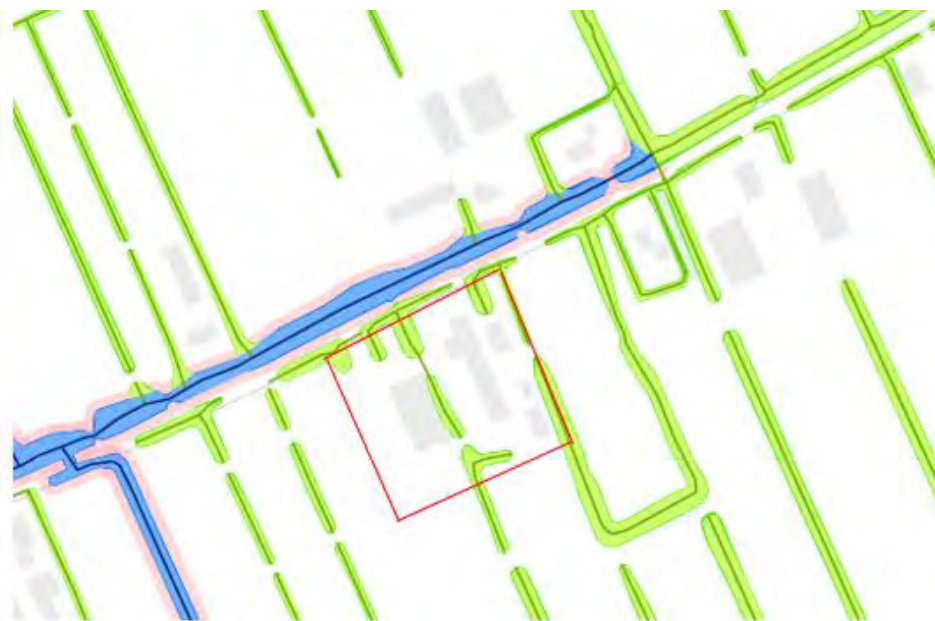
Legger oppervlaktewateren (bron: HSDR). Blauw betreft primair oppervlaktewater, groen is tertiair oppervlaktewater.
