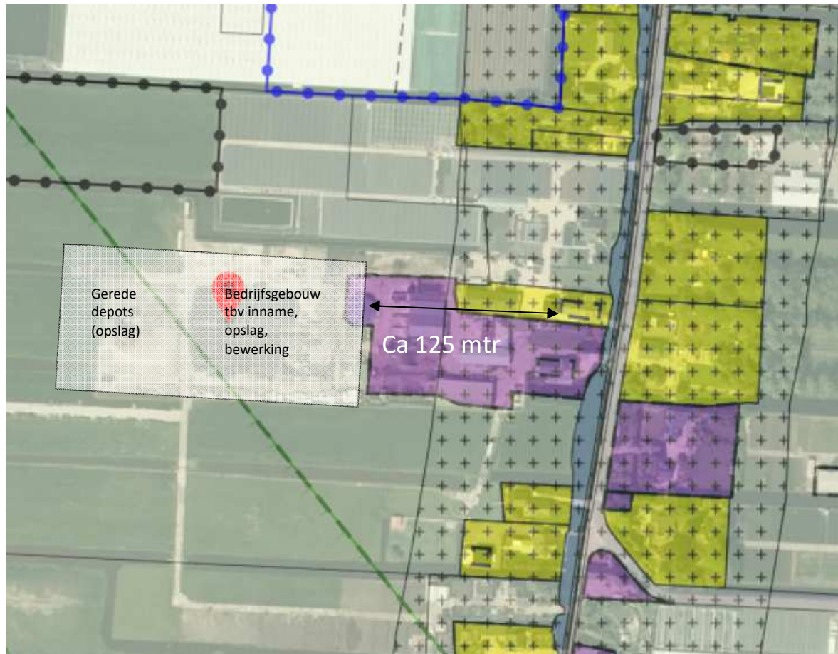
figuur 21: Weergave van activiteiten op terrein met mogelijke geurpotentie. Afstand tot dichtstbijzijnde gevoelig object (vaststaand bouwvlak) is circa 125 meter. Let op: compostering vindt niet plaats.
