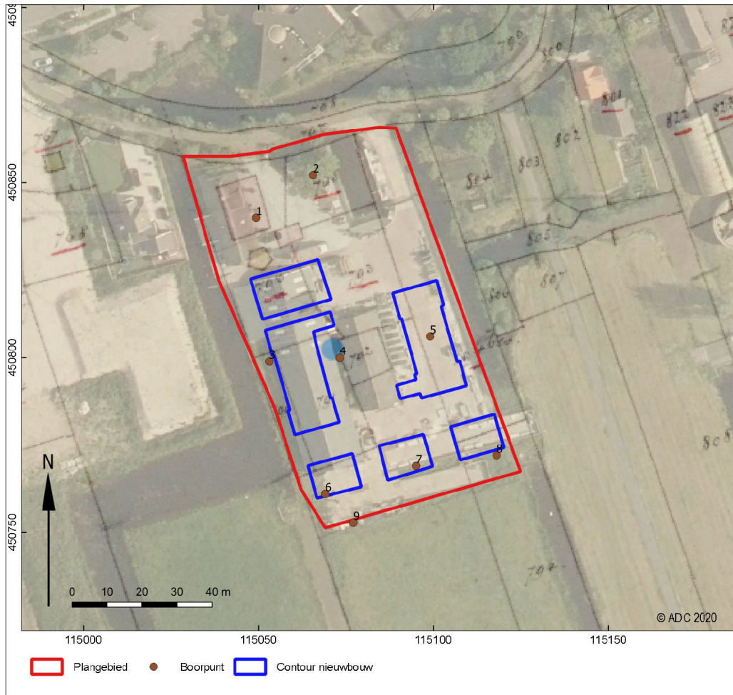
Afb. 17 Boorpunten en contour nieuwbouw geprojecteerd op kadastrale minuut uit 1811-1832 en recente luchtfoto
