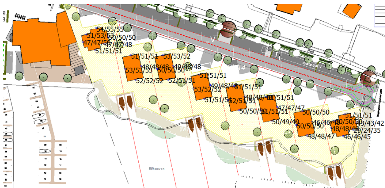
Figuur 4.4: Gecumuleerde geluidbelasting op gevels (voor aftrek), rekening houdend met beoogde bebouwing (oranje)
