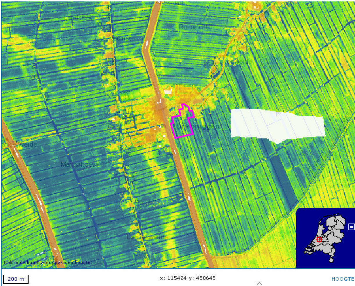
Afbeelding 5 Hoogtekaart van de onderzoekslocatie (paars omlijnd) en omgeving. Oranje is hoog en blauw is laag. Bron: www.ahn.nl .
