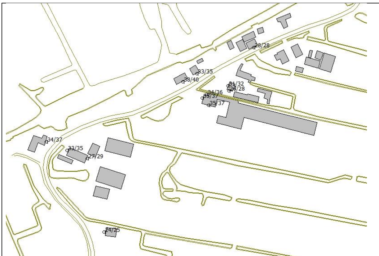
Figuur 6.5: Overzicht geluidsbelasting t.g.v. de verkeersaantrekkende werking bij alleen het gebruik van de zuidelijke in- uitrit.
