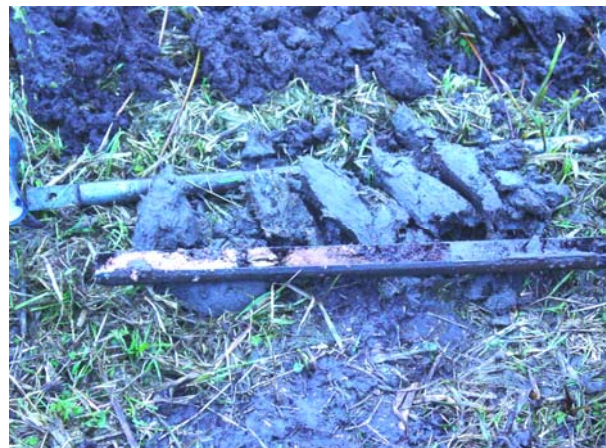
Afbeelding 9: opgeboord materiaal uit boring 001.
